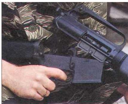
2. Поднимите верхнюю часть ствольной коробки. Она может быть отсоединена полностью после извлечения соединительного винта, находящегося перед гнездом магазина. Однако для неполной разборки это не обязательно.
