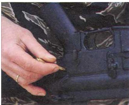
1. Откройте затвор, поставьте оружие на предохранитель и осмотрите патронник, чтобы убедиться в отсутствии в нем патрона. Нажмите кончиком пули на защелку ствольной коробки.
