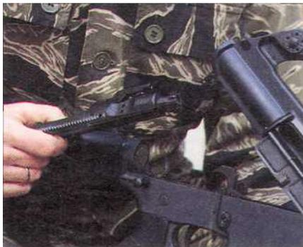
4. Извлеките затворную раму и затвор. Если оружие грязное, извлеките шпильку выбрасывателя и выбрасыватель для чистки.
