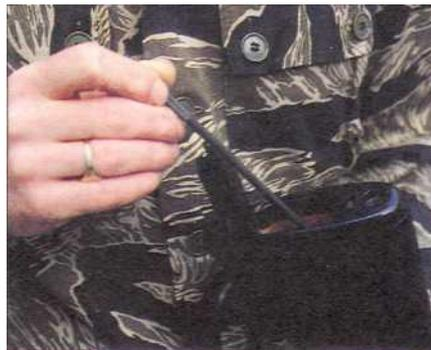
5. Эти принадлежности для чистки находятся внутри приклада каждой винтовки. Так как пороховые газы отводятся непосредственно в затворную раму, винтовку М-16 особенно важно содержать в чистоте.
