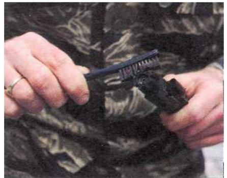
6. При чистке затвора проверьте его на отсутствие трещин и сколов. В особенности уделите внимание той части, которая находится вокруг ведущего выступа. Замените затвор, если он поврежден в районе гнезда ударника.
