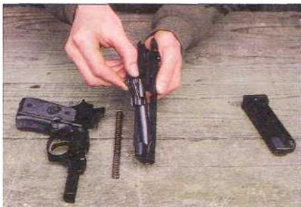
5. Нажмите на плунжер запирающего клина и извлеките запирающий механизм и ствол из кожуха, чтобы завершить разборку.
