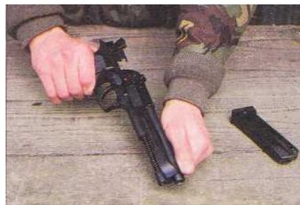
3. Потянув вперед, снимите кожух затвора с запирающим клином, возвратной пружиной и направляющей.
