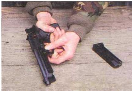
2. Возьмите рукоятку в правую руку. Левою рукой нажмите на соединительную шпильку. Поворачивайте ее против часовой стрелки до упора.
