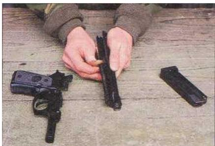
4. Нажмите на возвратную пружину и направляющую, чтобы извлечь их из кожуха затвора. Помните, что пружина находится в сжатом состоянии.
