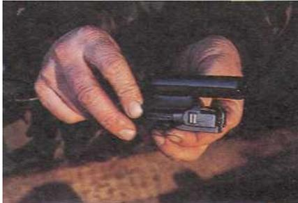
6. Поверните головку затвора на 90° и отсоедините затвор от затворной рамы. Извлеките ударник.
